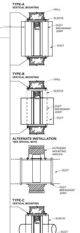
DUCT **BREAKAWAY** JOINT
